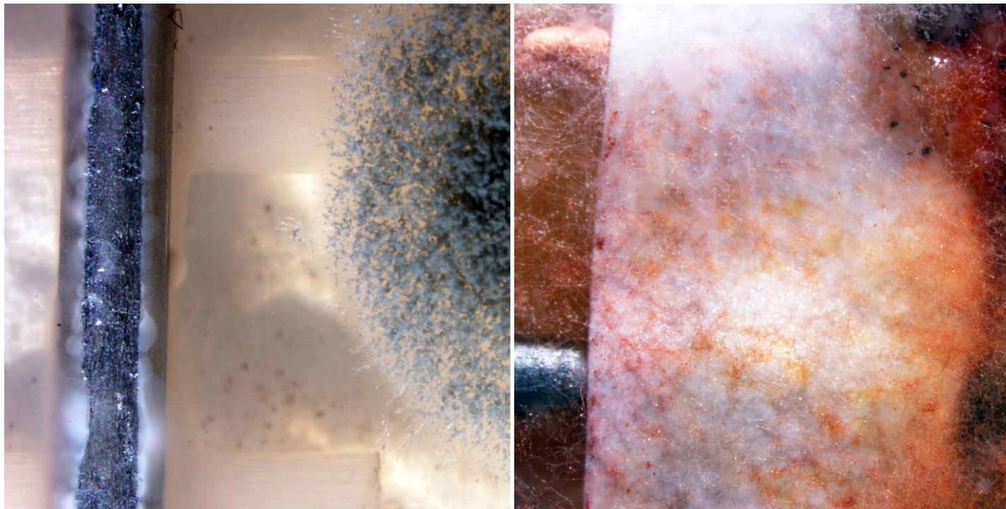
Strefy ochronne w obrazie mikroskopowym – sąsiedztwo elektrod Cu/Zn
